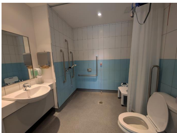
Salles de bain adaptées : douches accessibles, barres d'appui multiples, siège de douche amovible, toilette surélevée, robinetterie accessible et lève-personne.
